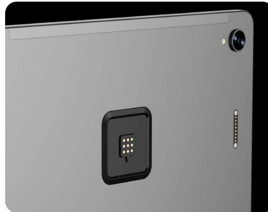
A: Pogo Pin 9-pin Interfaces
